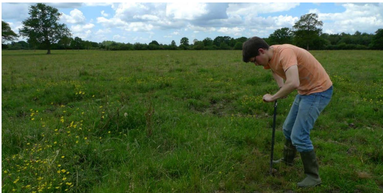
Prélèvement à l'aide d'une tarière pédologique - Calidris
